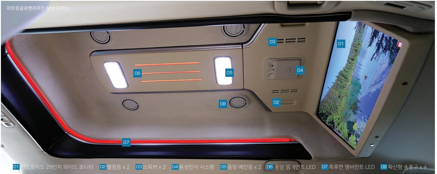
01 안드로이드 29인치 와이드 모니터 02 웰컴등 x 2 03 스피커 x 2 04 음성인식 시스템 05 중앙 메인등 x 2 06 중앙 앰비언트 LED 07 측후면 앰비언트 LED 08 확산형 송풍구 x 4
